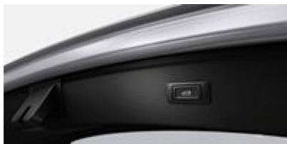
Gepäckraumklappe, elektrisch öffnend und schließend
